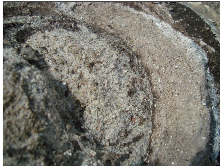
Querschnitt einer CSV-Säule (entnommen während Herstellung der Bohrpfähle für die Brückengründung am 24.07.2018)
