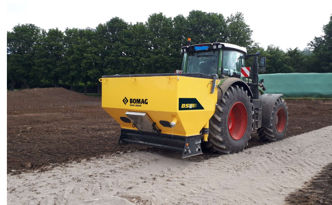
BS 5 Fassungsvolumen 5,5 m 3 Arbeitsbreiten 0,8 / 1,6 / 2,40 m
