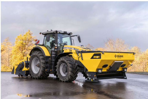
BS 3 Fassungsvolumen 3,5 m 3 Arbeitsbreiten 0,8 / 1,6 / 2,40 m
