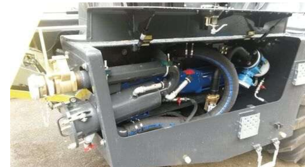
Bitumen-Emulsionspumpe mit Vorfilter und Durchflussmesser
