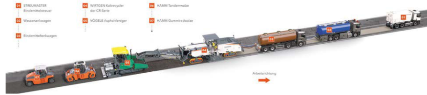
Kaltrecyclingzug mit der CR-Serie und Heckverladung in den Fertiger – Mischkapazität bis zu 800 t/h
