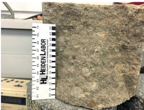
Abbildung 3: Typisches Bruchbild eines Probekörpers aus einer Verfestigung nach 28 Tagen, hergestellt aus rezyklierter Gesteinskörnung einer ehemaligen Tragschicht mit hydraulischen Bindemitteln und Zement.
