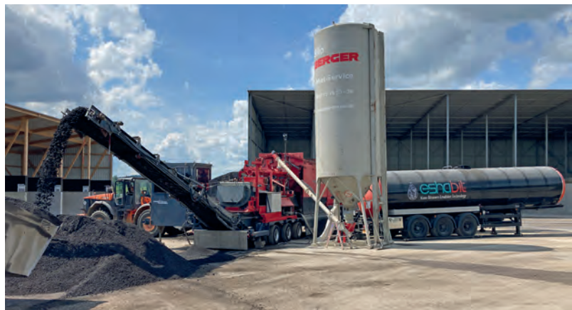
Anlagenkomplex mit installierten hydraulischen und bituminösen Bindemitteln
