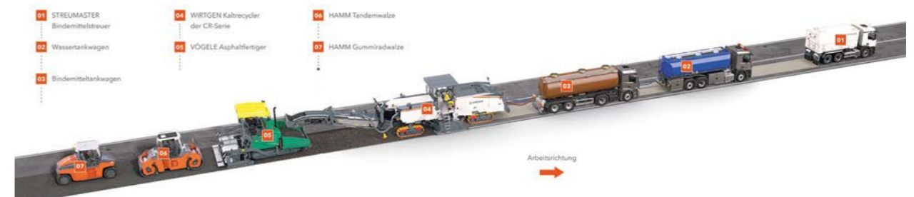
Kaltrecyclingzug mit der CR-Serie und Heckverladung in den Fertiger – Mischkapazität bis zu 800 t/h
